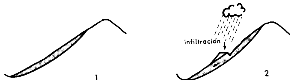
Figura 4.—Reactivación de un Deslizamiento Latente por una Carretera.
